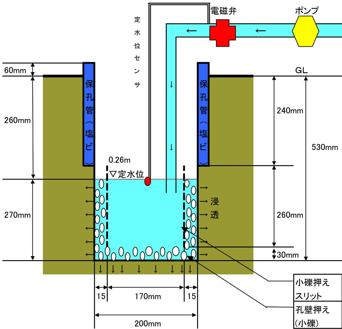
浸透側溝試験孔 見取り図
