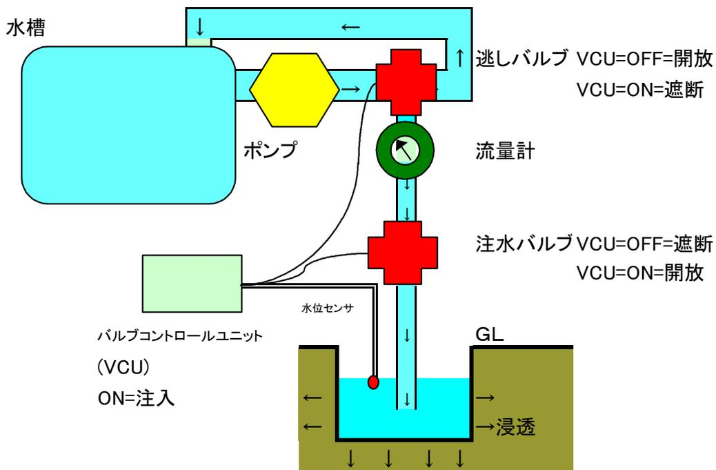
定水位透水試験ソレノイドバルブシステム概略図
